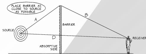
THE KEY DIMENSIONS IN ESTIMATING BARRIER ATTENUATION ARE THE STRAIGHT LINE DISTANCE BETWEEN THE SOURCE AND THE RECEIVER (D) AND THE SHORTEST PATH AROUND THE BARRIER (A+B)
